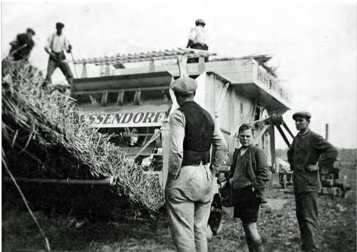
De foto's van het dorsen zijn op dezelfde plaats genomen in de jaren veertig. We vermoeden bij 'Lienes'. Beire volgt de werkzaamheden (foto boven bij de motoraandrijving en onder met handen in de heup). Het kaf vliegt via een buisleiding en trechter met zak op een hoop. Het stro komt achter uit de deusmeulen en wordt gestapeld. De granen worden vooraan opgevangen in zakken en direct gewogen en dichtgemaakt. De oude bascule staat er ook nog bij.
