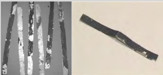
Dunne strookjes zilverpapier werden met duizenden tegelijk uit vliegtuigen gegooid om de Duitse radar te verstoren.
