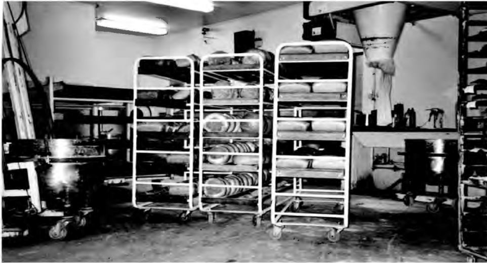
Er worden nu twee mobiele “petrains” gebruikt om te kneden. De bloem wordt er rechtstreeks van uit de bovengelegen containers en via de vultrechter ingelaten.
